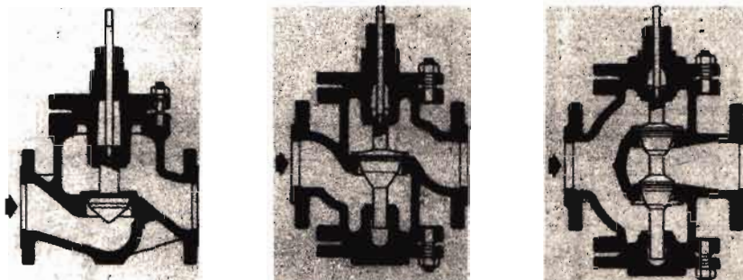
Fig. 3.30 Doorsnede van drie zittingkleppen
