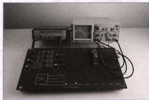
Fig. 3.8 Stroom- en spanning-tijd-diagram van een zuiver ohmse kring Oscilloscoopmeting op een zuiver ohmse kring
